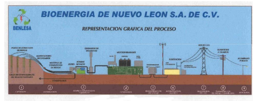
Figura 54. Proceso de aprovechamiento energético de biogás proveniente de un relleno sanitario (BENLESA, Nuevo León). Fuente: (BENLESA, 2010)
